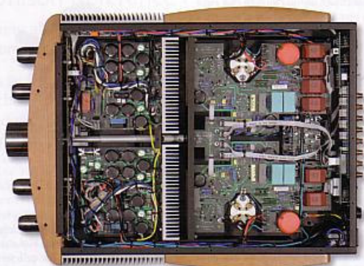
Stromversorgung (links) und Signalverarbeitung (rechts) werden strikt getrennt
