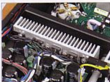
Leistungs-MOS-FETs kümmern sich um die Säuberung der Anodenspannungen
