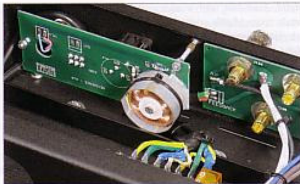
Hinter den symmetrischen Kontakten sitzen Übertrager, daneben sind die Lautsprecherklemmen zu sehen
